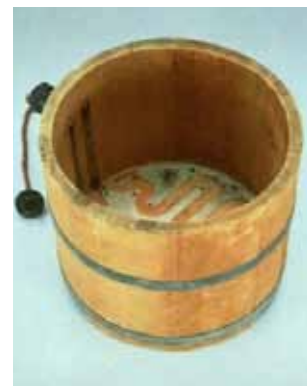
Электрическая рисоварка Ибуки не принесла изобретателю коммерческий успех: применять ее с устойчивым результатом оказалось невозможно. Фото: Sony Electronics Inc.
